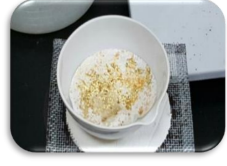
圖15 步驟4-1, 將過濾後合金的濾紙去燒乾。
