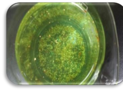
圖13 步驟3-2, 將金箔與廢液過濾分離。
