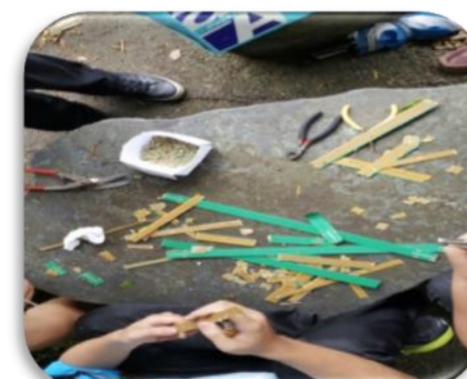
圖19 步驟1-2, 將破碎後的IC版邊料,加以裁剪取出合金部分。
