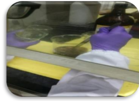
圖12 步驟3-1, 將硝酸浸泡之廢料夾取出來。
